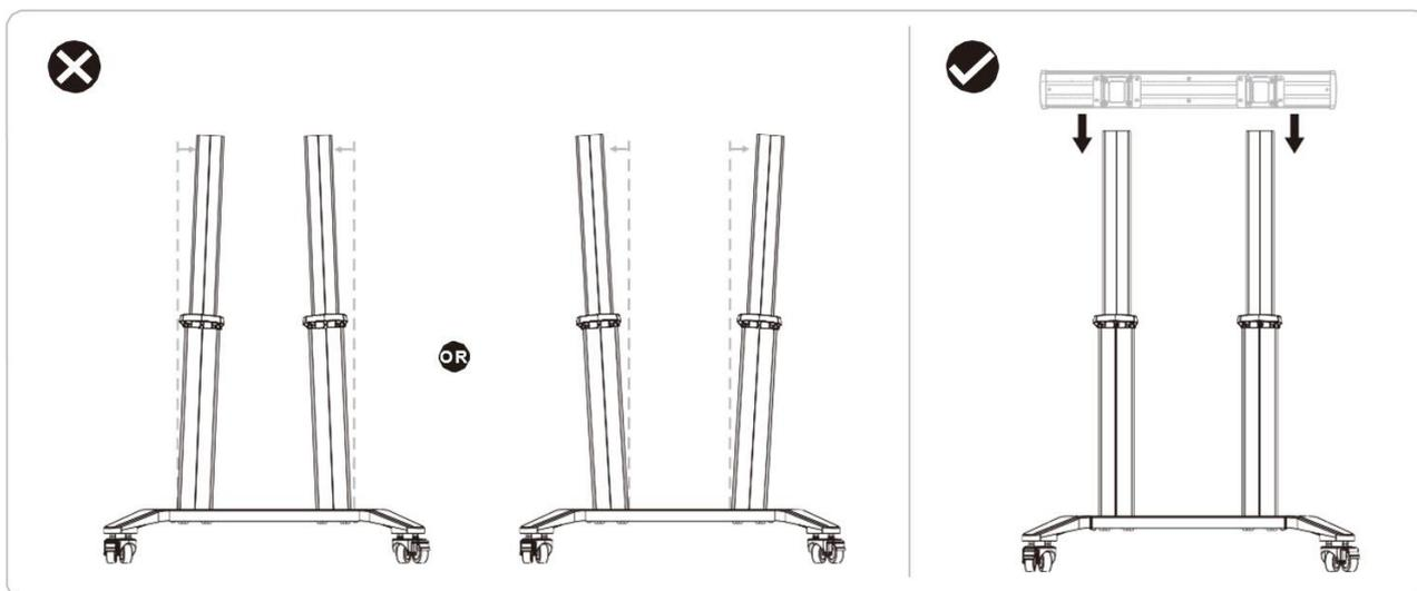
Wenn die Säulen nicht richtig ausgerichtet sind, lässt sich die Montageplatte möglicherweise nicht an den Säulen befestigen. Führen Sie die folgenden Schritte aus, um die Säulen wieder zu montieren.
